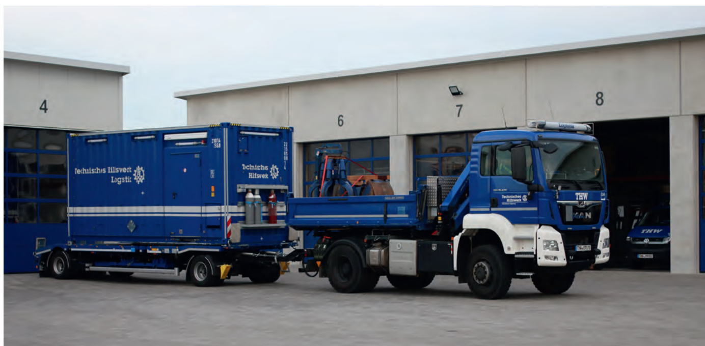
Ein Gespann: der Kipper mit Ladekran mit Multifunktionsanhänger und Werksattcontainer des Ortsverbands Augsburg.
