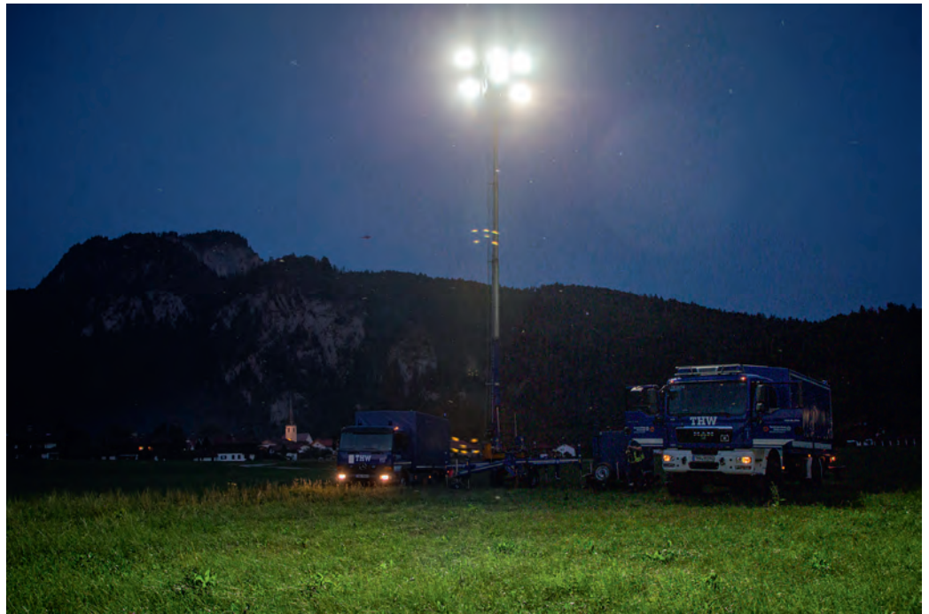
Die Sechs Stadion-Scheinwerfer des Lichtmast schaffen eine Lichtleistung von 1,2 Millionen Lumen - vergleichbar mit 65.000W Halogenstrahlern.
