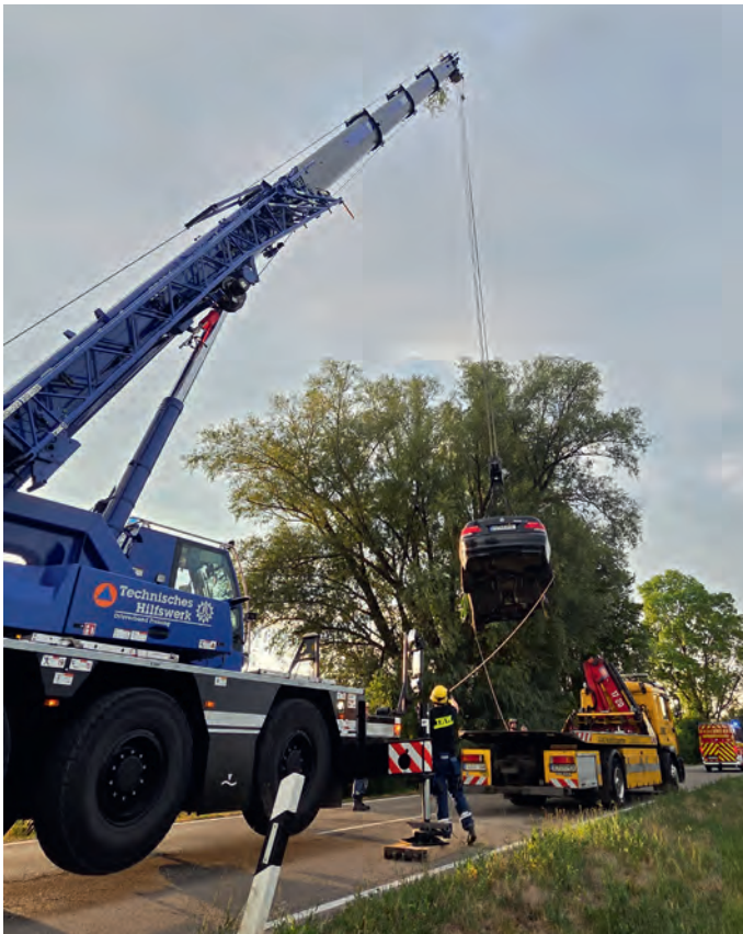
Das verunfallte Fahrzeug wird vom Kran aus dem Feld gehoben und auf die Ladefläche des Abschleppfahrzeugs verbracht. Der Abtransport des PKW ist Aufgabe des Abschleppers, der die Unfallstelle mit seinen Mitteln nicht erreichen konnte.
