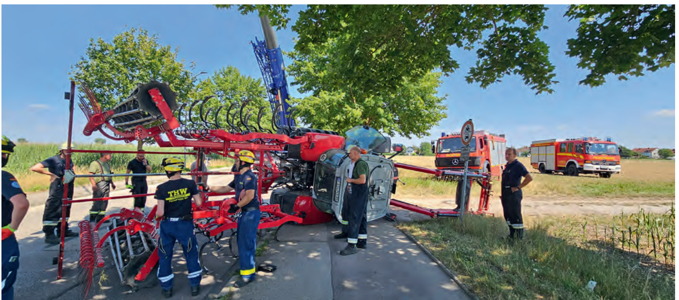
Vorbereitungen zum Entfernen des Anbaugeräts. Dieses war an den Aufnahmen stark unter Spannung und es musste verhindert werden, dass weitere Schäden entstanden. Die eingesetzten Kräfte von THW und Feuerwehr arbeiteten hier Hand in Hand.
