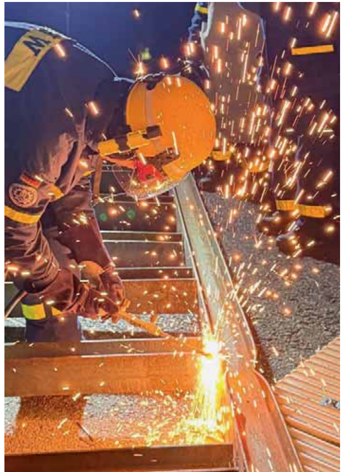
Großer Funkenflug beim Ausbildung im Brennschneiden.
