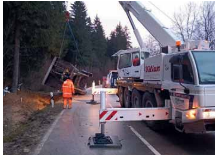
Bergung des Auflegers durch das Bergeunternehmen mit Kran
