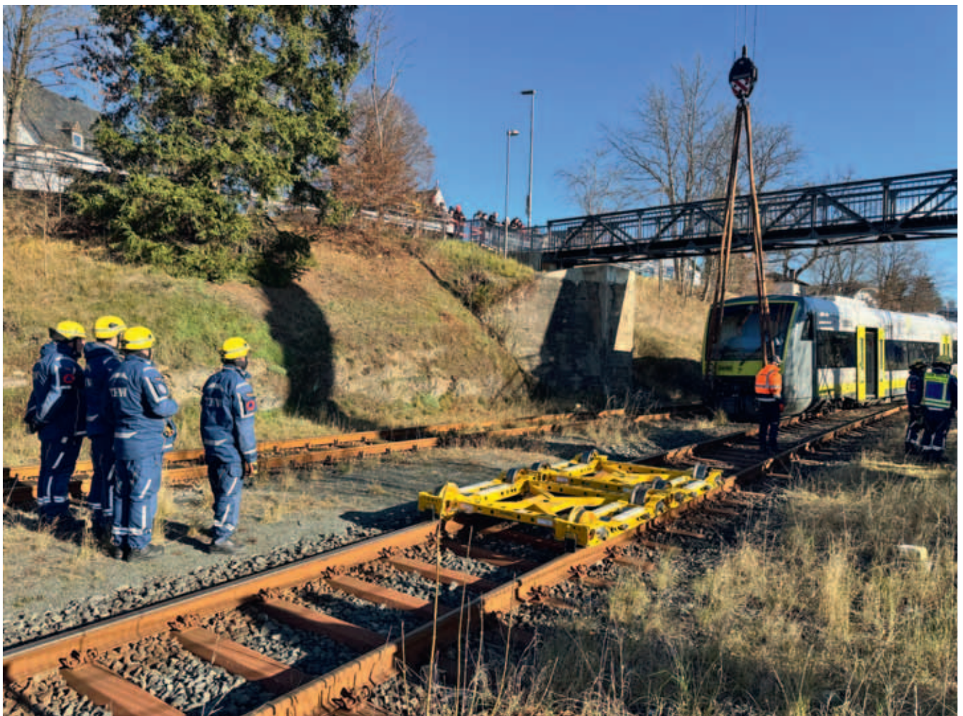
Anheben des Zuges mittels 250-t-Kran
