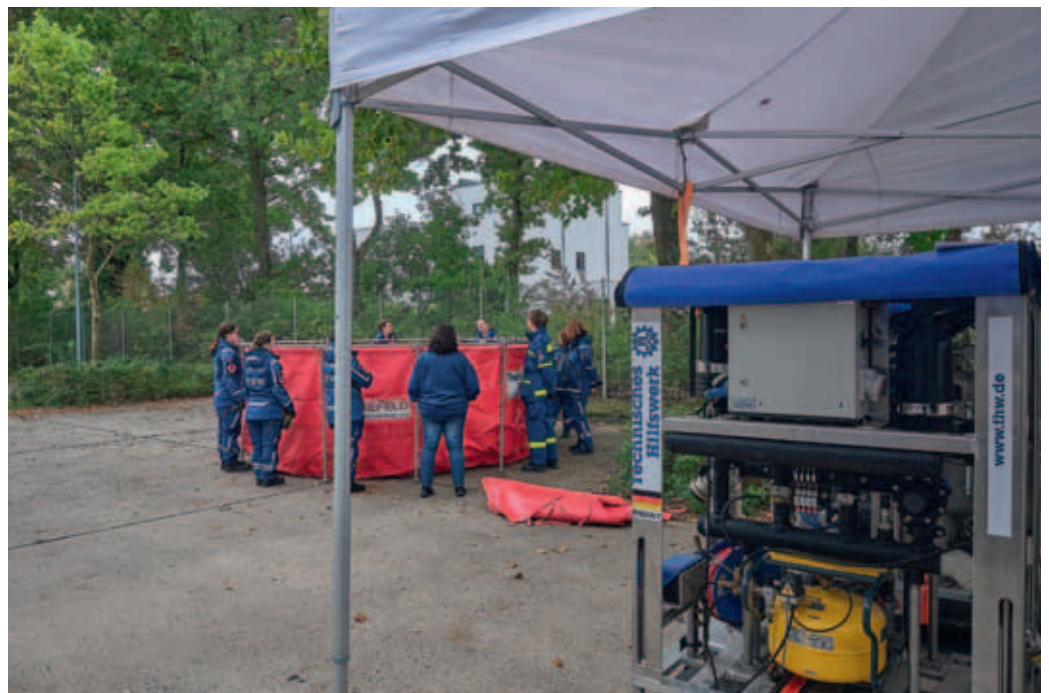
Trinkwasserversorgung – In dem roten Becken wird das Wasser der ersten Filterung unterzogen.
