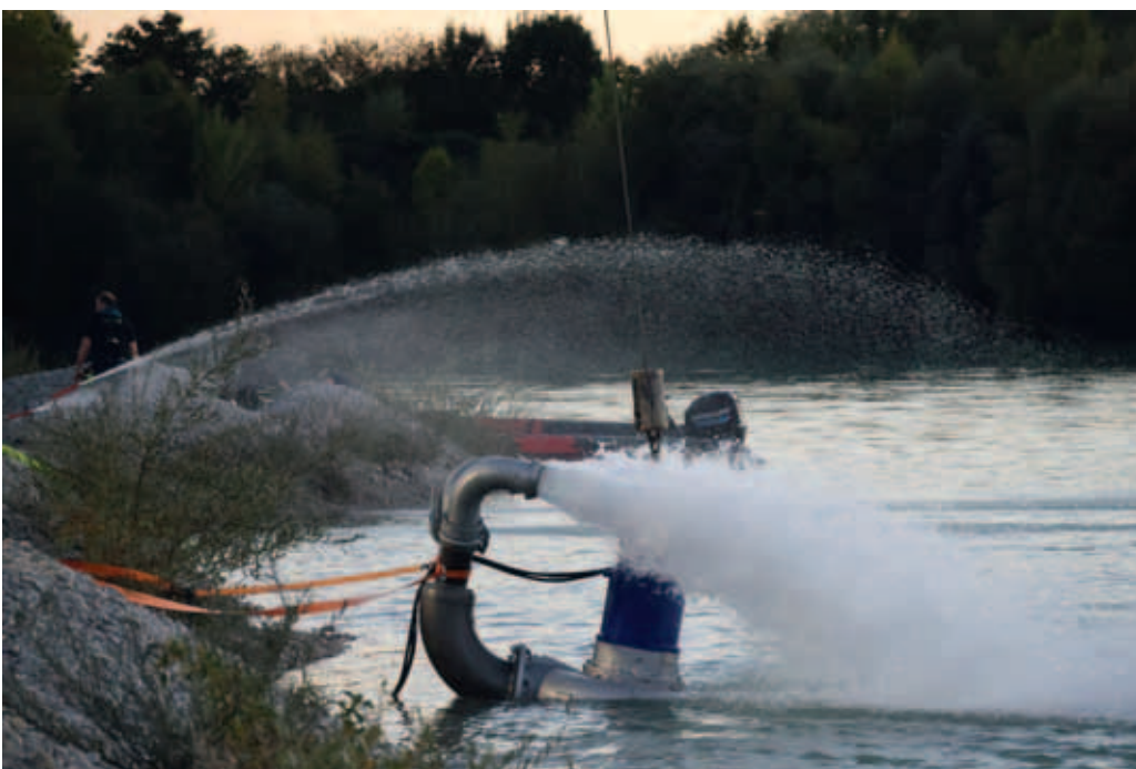
Die Elektropumpe hat eine Förderleistung von 13.000 l/min.
