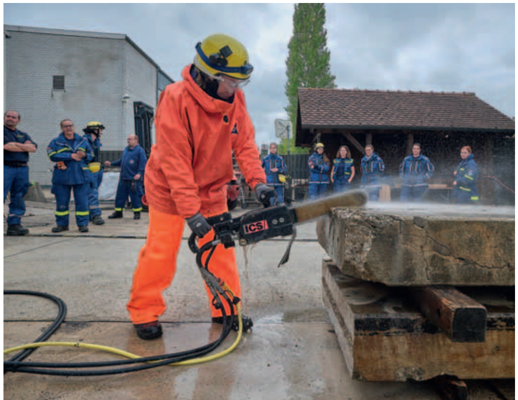
Schwere Bergung – Arbeiten mit der Betonkettensäge
