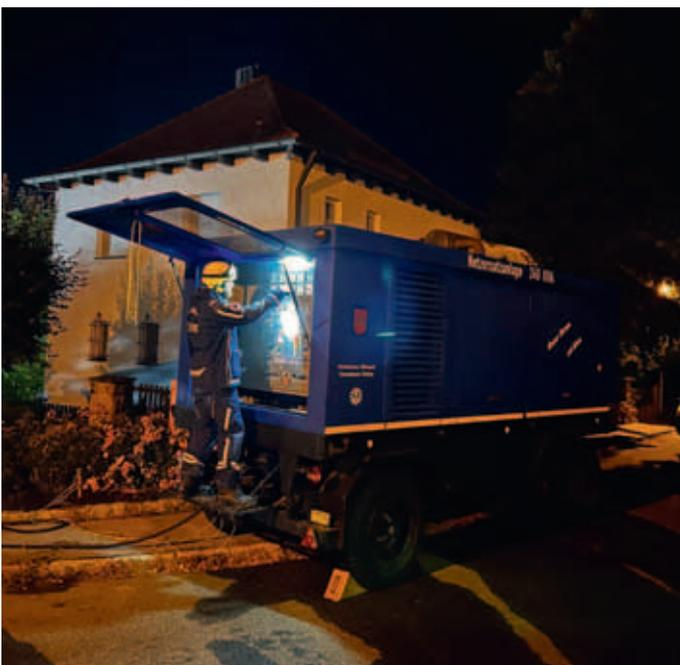
Die Netzersatzanlage des THW Roding versorgte das Wasserschneidgerät der Sprengmeister mit Strom.
