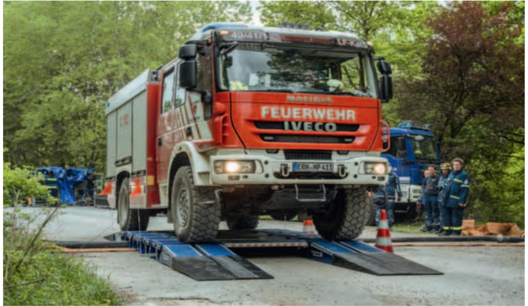
Schwere Schlauchbrücken ermöglichen die problemlose Überwegung allen eingesetzten Schlauchmaterials.
