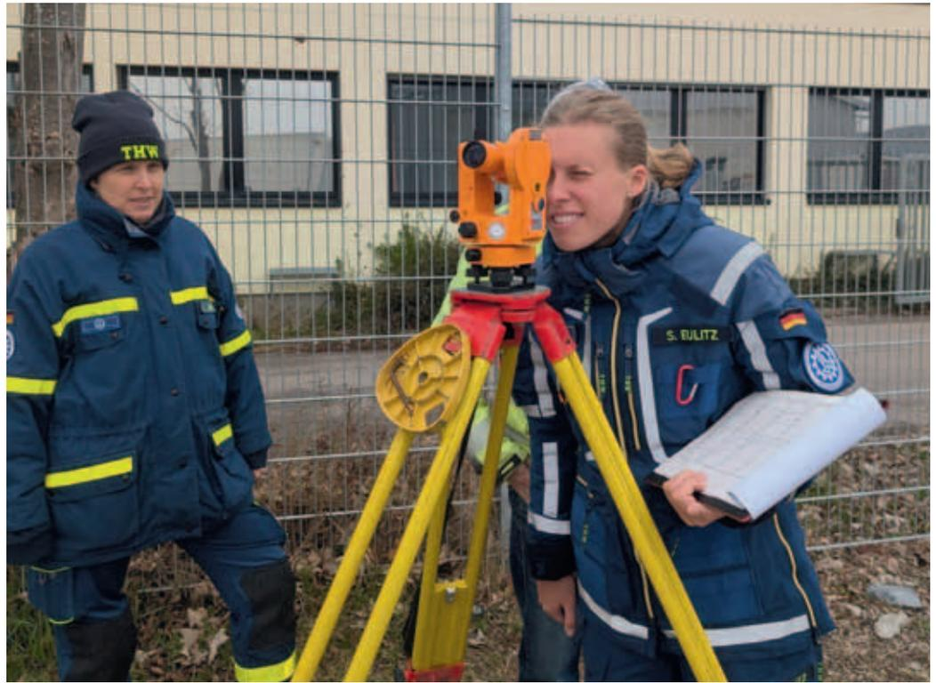
Messen von Vertikal- und Horizontalwinkeln mit dem optischen Theodoliten
