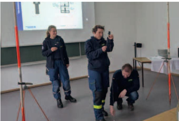
Bestimmung eines Punktes zwischen zwei Fluchtstäben mit dem Doppel-pentagonprisma und Senklot
