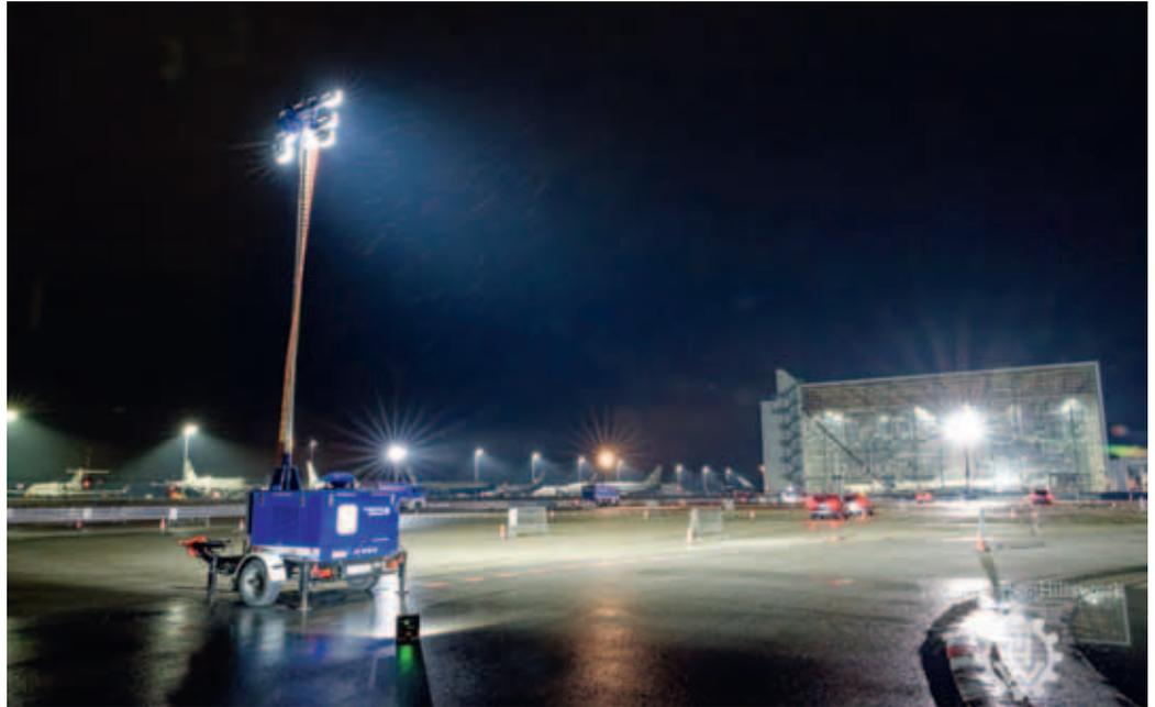
*Mit den Lichtmasten an den Gruppenfahrzeugen des Ortsverbands werden üblicherweise die eigenen Einsatzstellen ausgeleuchtet. Hier werden die Lichtmasten, ältere noch in Halogen- und Metaldampftechnik, neue in moderner LED-Technik, genutzt, um die Flächen blendfrei auszuleuchten.*
