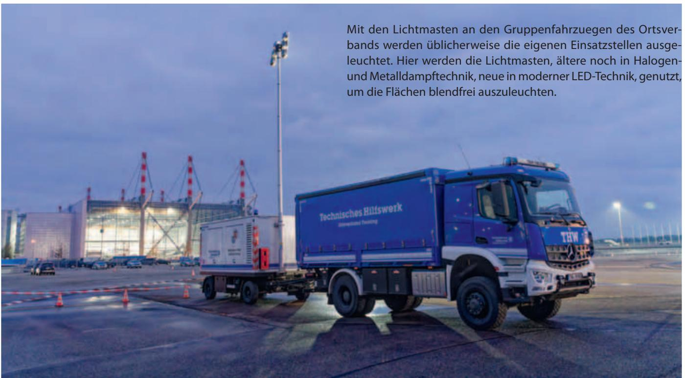
*Mit den Lichtmasten an den Gruppenfahrzeugen des Ortsverbands werden üblicherweise die eigenen Einsatzstellen ausgeleuchtet. Hier werden die Lichtmasten, ältere noch in Halogen- und Metaldampftechnik, neue in moderner LED-Technik, genutzt, um die Flächen blendfrei auszuleuchten.*
