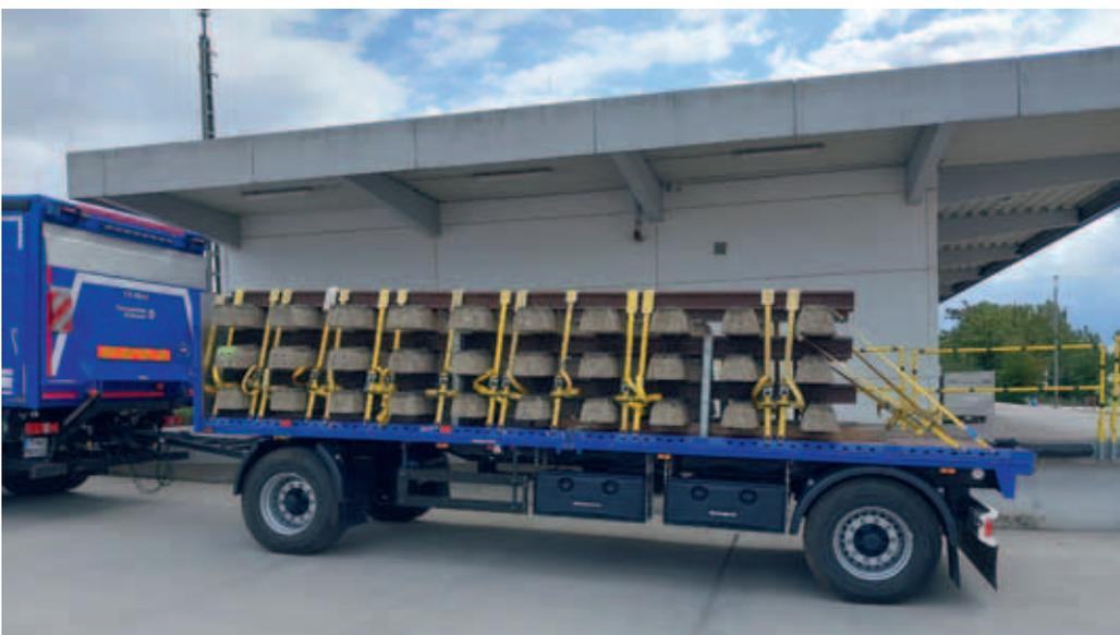
Transport der Gleisjoche mit montierten Schwellen mit dem Multifunktionsanhänger der FGr. Brückenbau
