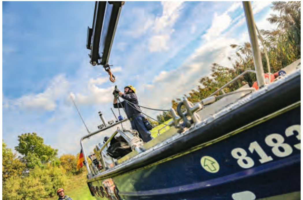
Carsten Zange hakt das Mehrzweckarbeitsboot ein, so dass der Kran dieses ins Wasser heben kann.
