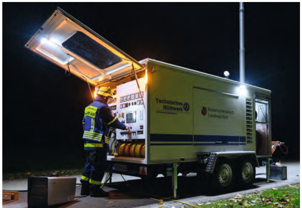
Die neue Netzersatzanlage des Landkreises Roth (Mittelfranken) sorgt bei der Übung für die zentrale Stromversorgung und besteht tadellos ihre Premiere.
