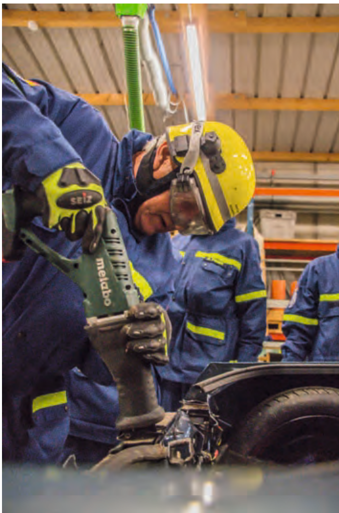
Albert Kastl schneidet mit der Säbelsäge einen Ausschnitt in den Kofferraumrahmen, damit der verletzte Fahrer schonend gerettet werden kann.
