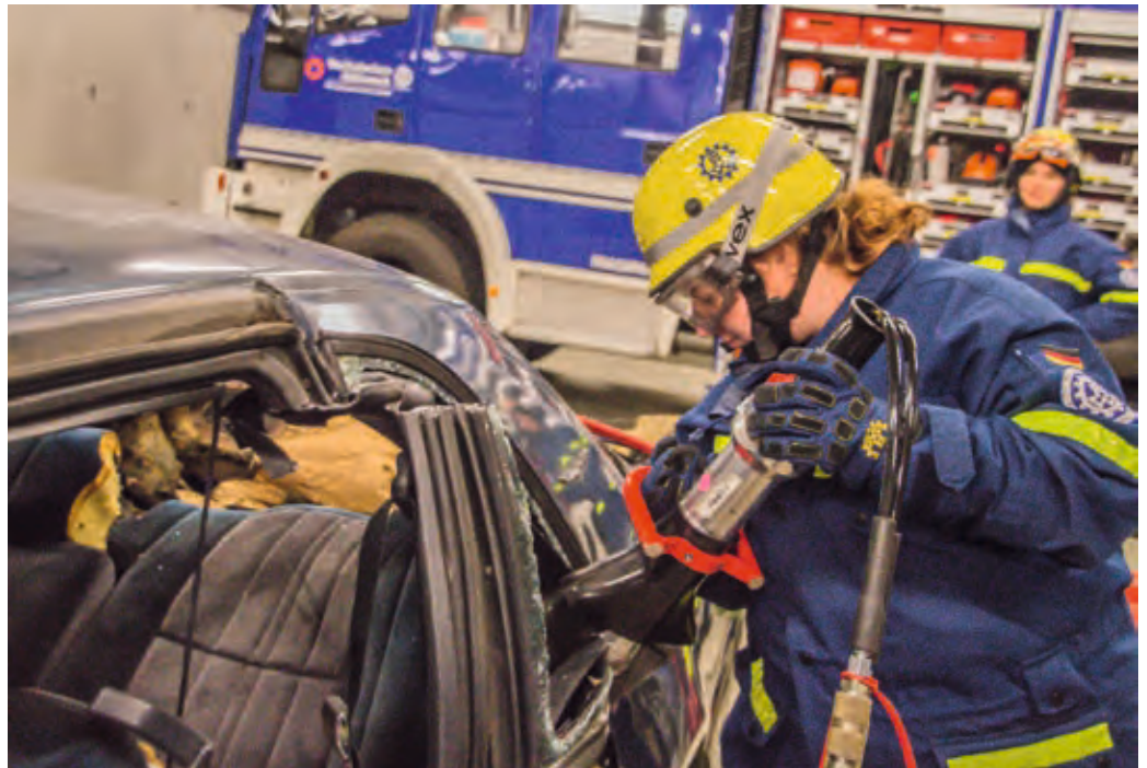
Karoline Kötter schneidet mit der Schere eine Öffnung in das hintere Fenster, damit mehr Platz für die Rettung über die Türe (als zweite Variante) für die Helfer da ist.
