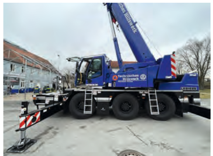
Der neue Mobilkran der Fachgruppe Brückenbau, ein Liebherr LTC1050-3.1
