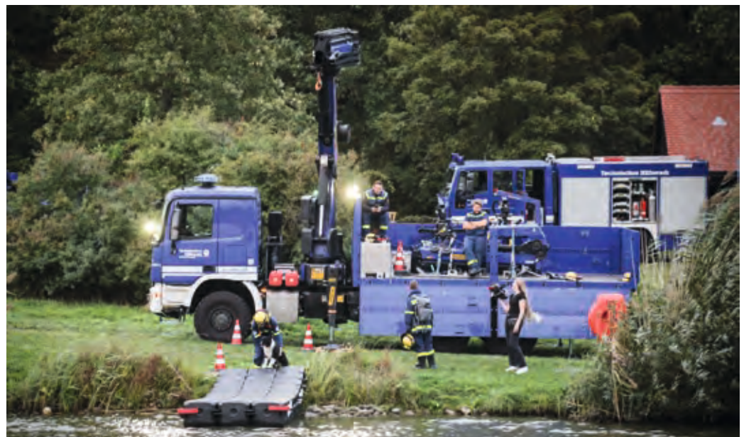
Der Jet-Float-System-Anleger. Das Jet-Float-System besteht aus würfelförmlichen Einzelelementen, welche zu beliebig großen Flächen verbunden werden können.
