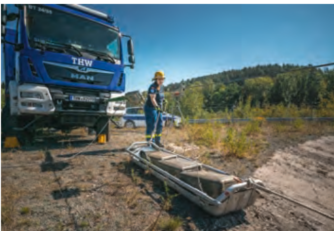
Casandra Arlt (OBAY) macht sich bereit für den Materialtransport mit der Schleifkorbtrage an der errichteten Seilbahn. Ankerpunkt: Einsatzfahrzeug.
