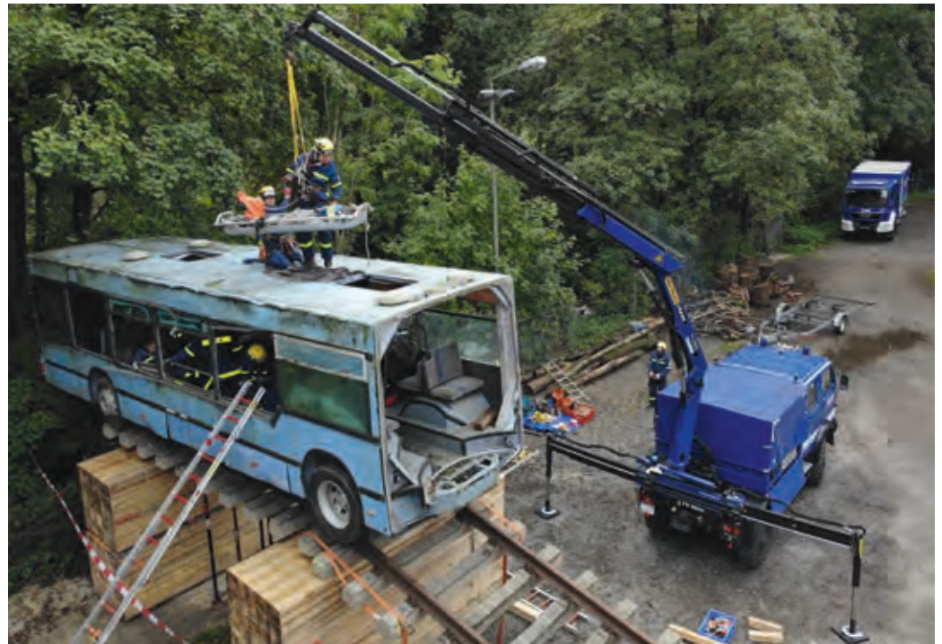
Drohnenaufnahme: Rettung einer verletzten Person vom Fahrzeugdach mittels Schleifkorb und Ladekran.
