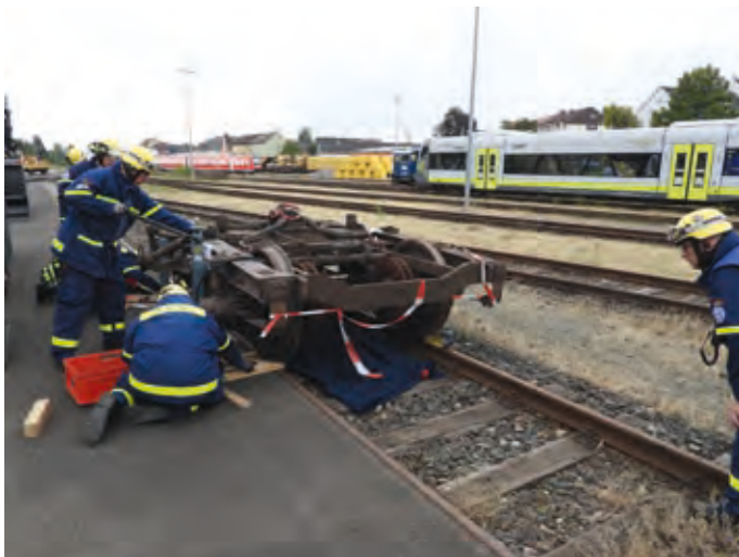
Mit einer sogenannten Büffelwinde wurde ein Drehgestell angehoben, um darunter liegende Übungspuppen bergen zu können.
