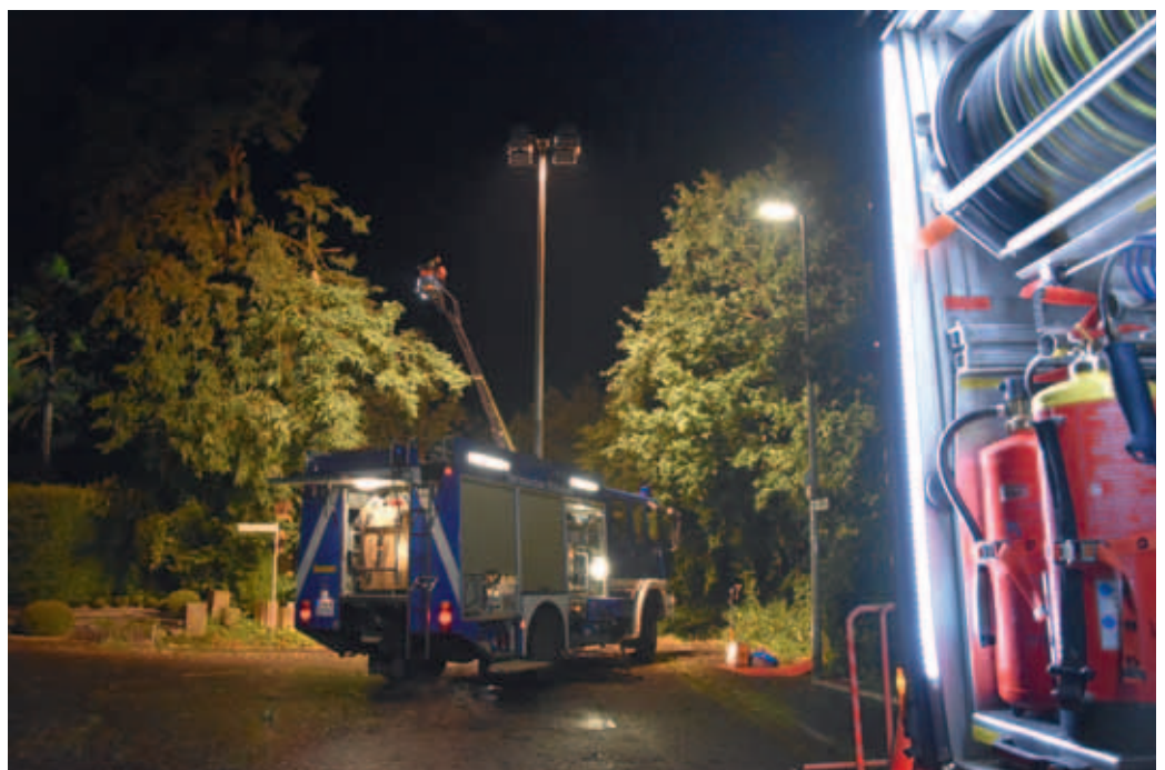
Ausleuchtung der Einsatzstelle mittels GKW-Lichtmastes.
