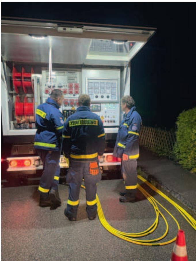
Elektrofachkräfte des THW überwachen die Stromabgabe über das Bedientableau des Aggregats.
