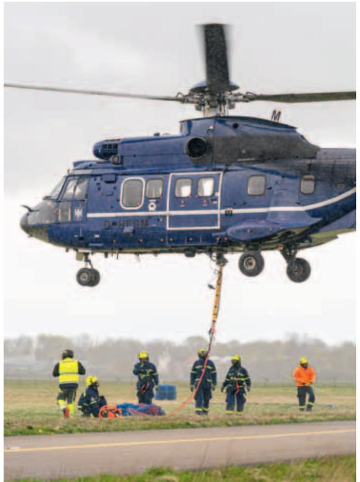
*Am Hubschrauber wird ein Transportnetz für Außenlasten befestigt.*
