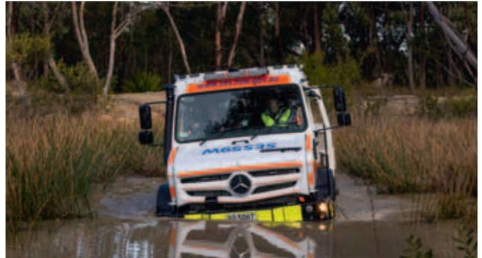
SES Australien Unimog U 4023, wadfähig bis 1,2 m
