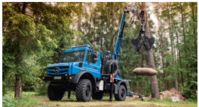
U 5023; mit Löffelbagger von Ematec (M213) und Reifendruckregelanlage beim Kampfmittelräumdienst Niedersachsen
