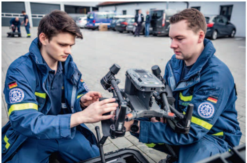
*Drohnen Grundgerät. Nach der Montage der Landestelle, dem Ausklappen der Rotorarme und dem Einstecken der Hochleistungsakkus ist das Fluggerät startbereit*
