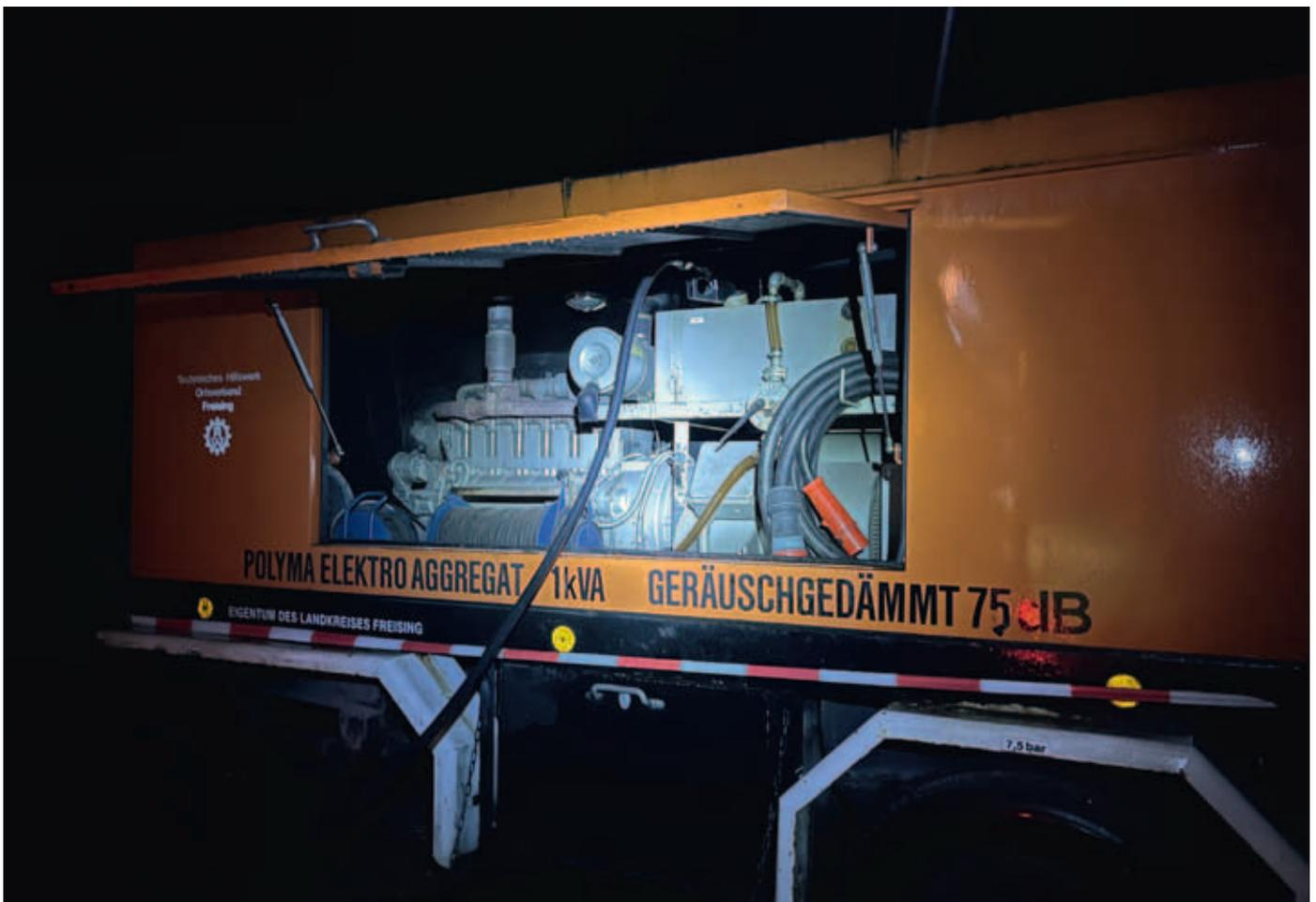
*Geräteraum in analoger Technik des mittlerweile über 40 Jahre alten Notstromaggregats mit 61 kVA Leistung.*
