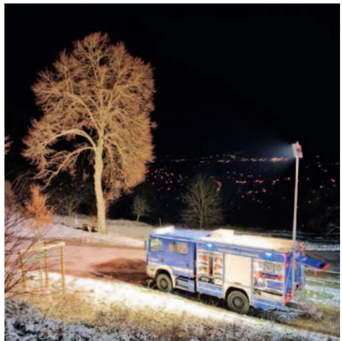
Der Gerätekraftwagen bzw. dessen Lichtmast wurde zur Erstbeleuchtung eingesetzt. Foto: Renate Wolf
