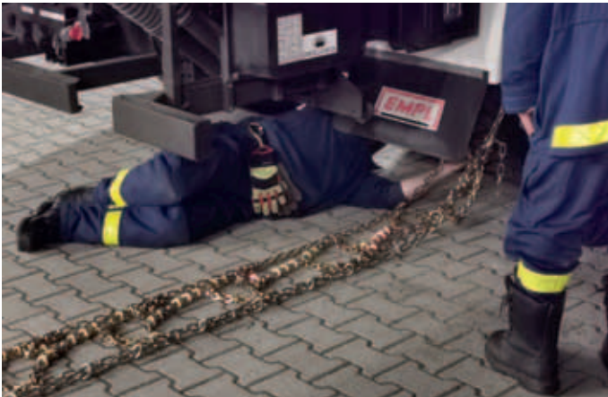
Die Ketten werden auf dem Boden ausgebreitet und vorbereitet, richtige Ausrichtung geprüft und am Reifen angebracht
