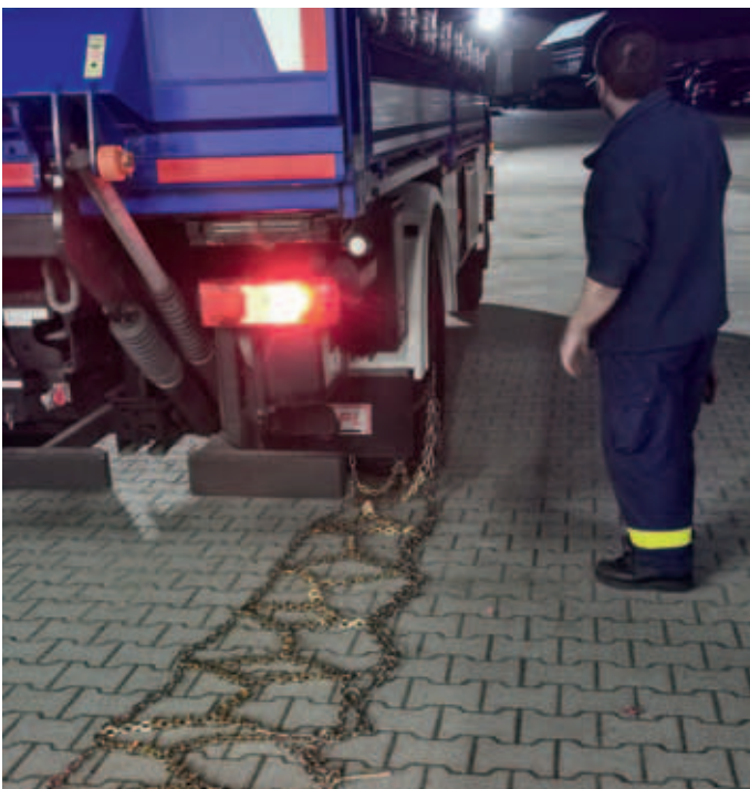
Sind die Ketten am Reifen angebracht, fährt der Kraftfahrer ein Stück weit vor, um so die Ketten auf die Räder aufzuziehen.
