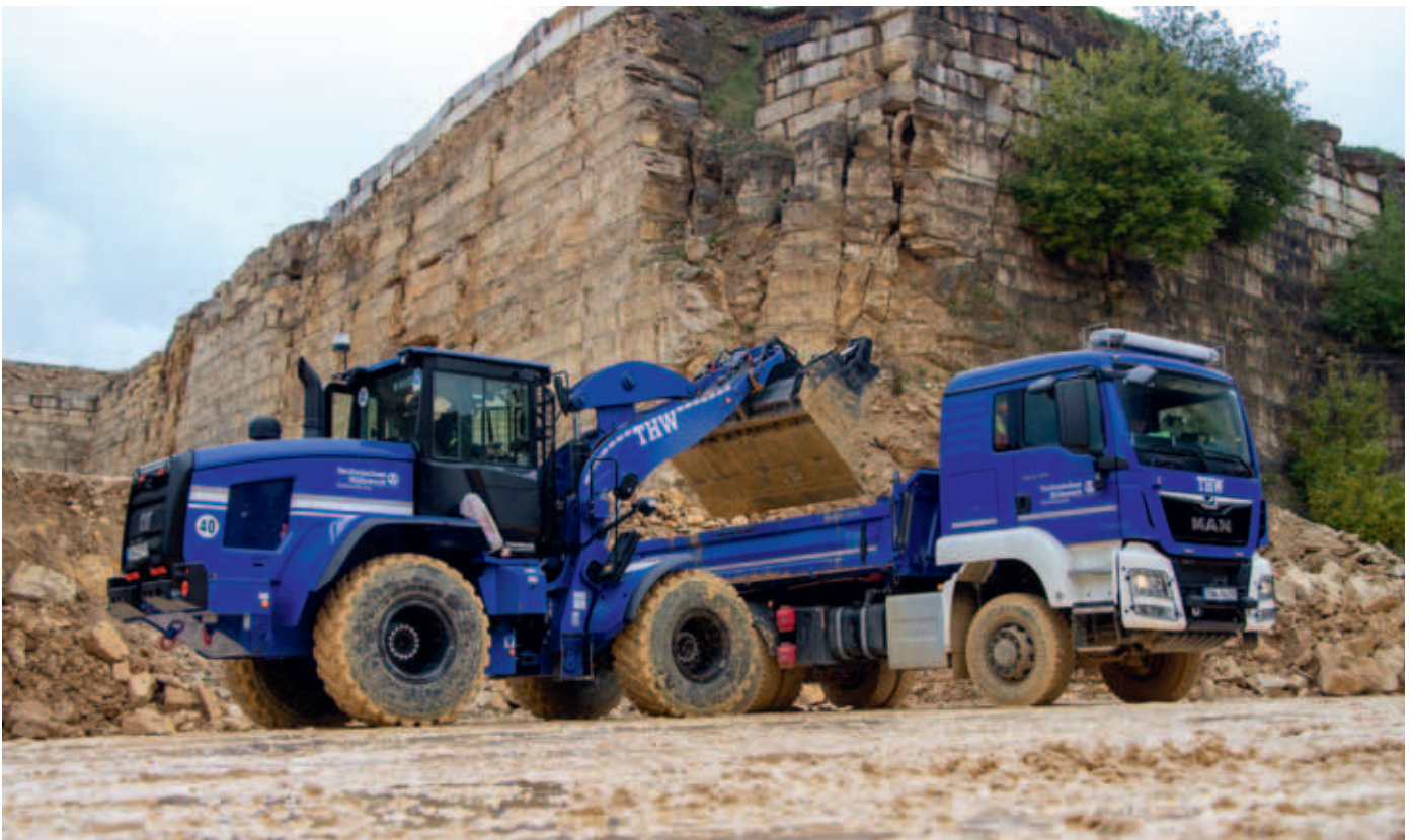
Das nasse Material verhält sich ganz anders als trockenes Gestein und Geröll und erschwert das korrekte Beladen der Dreiseitenkipper.
