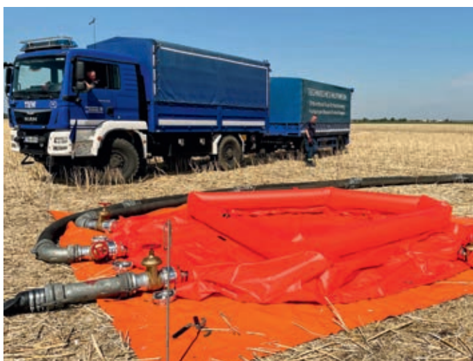
Am Ende der Schlauchstrecke wurde ein 25.000 l fassendes Becken positioniert, welches unter anderem von Helikoptern zur Löschwasser-Aufnahme genutzt wurde.
