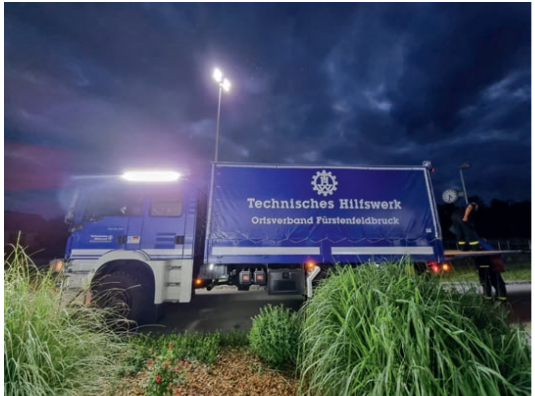
Ausleuchten einer Einsatzstelle mit MzKW und pneumatischem Lichtmast.
