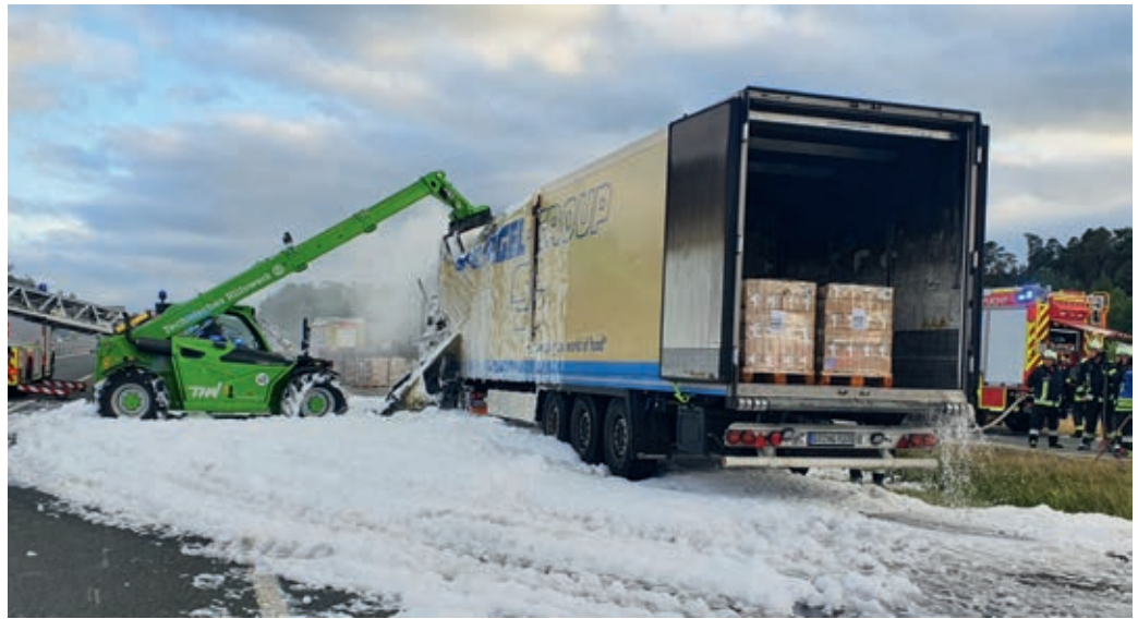
Die Wände des Aufliegers wurden mit der Niederhalterschaukel des THW-Teleskopladlers geöffnet, um die Ladung ablöschen zu können.
