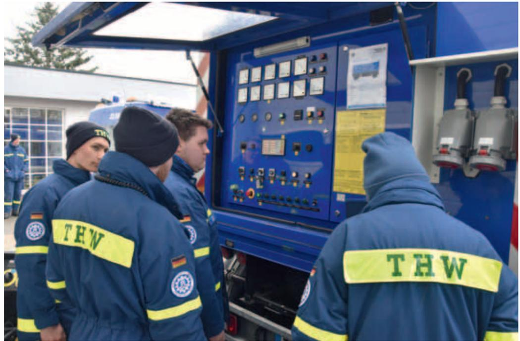
„Im Gleichklang“: Bei Synchronisation und Rücksynchronisation von Netzersatzanlagen kommt es auch auf den richtigen Zeitpunkt an.
