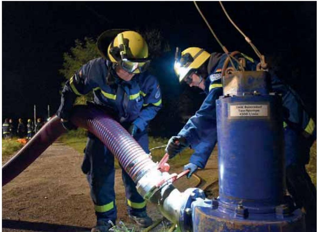
Zwei THWler verbinden einen F-Schlauch mit der großen Tauchpumpe, die eine Förderleistung von 4300 l/min besitzt.
