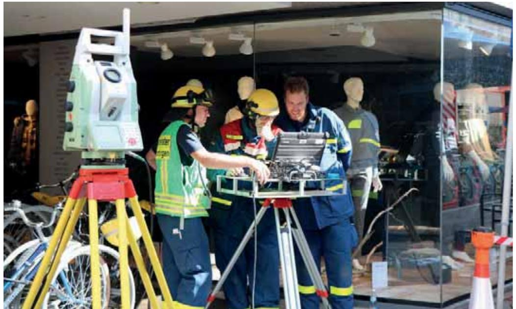
Mit dem ESS (Einsatzstellen-Sicherungssystem) wurde das Gebäude auf ungewöhnliche Bewegungen hin überwacht. (oben) Die Spiegelprismen für das ESS werden angebracht und eingerichtet (unten)
