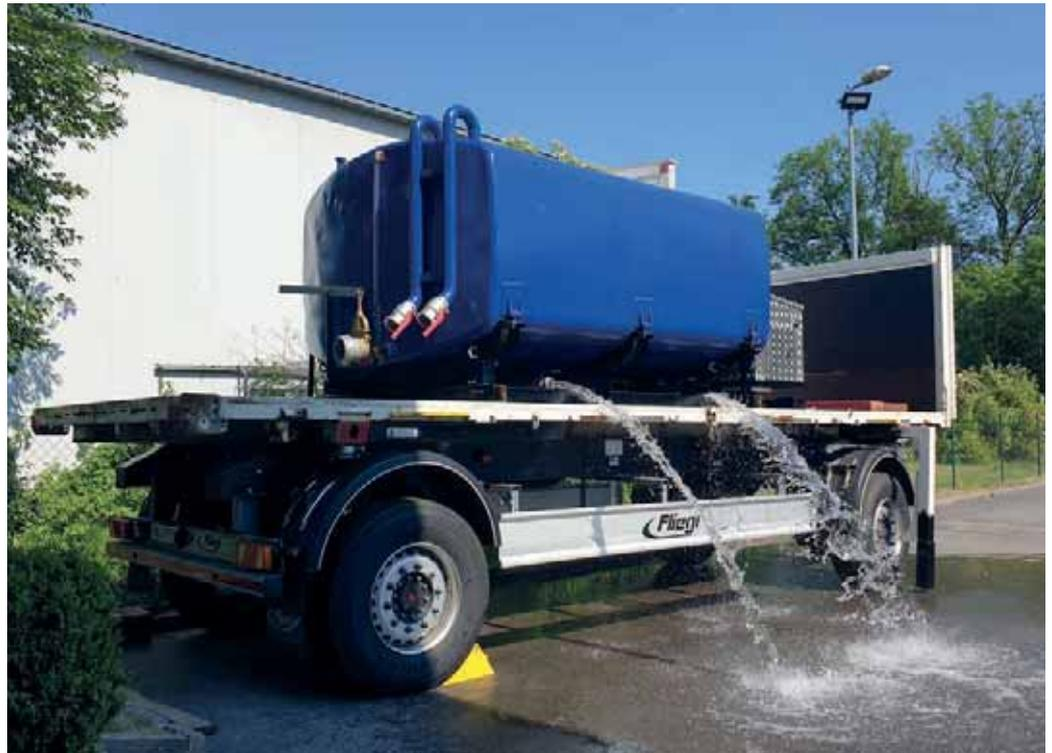
Der Wassertank auf dem Auflieger mit der Wechselbrücke steht ab Waldbrandstufe 3 einsatzbereit auf dem Hof und kann jederzeit an ein Zugfahrzeug angekoppelt werden. Am Gestell für den Wassertank ist eine große Box fest angebaut, die als Lager für Adapter und Verteilerstücke dient
