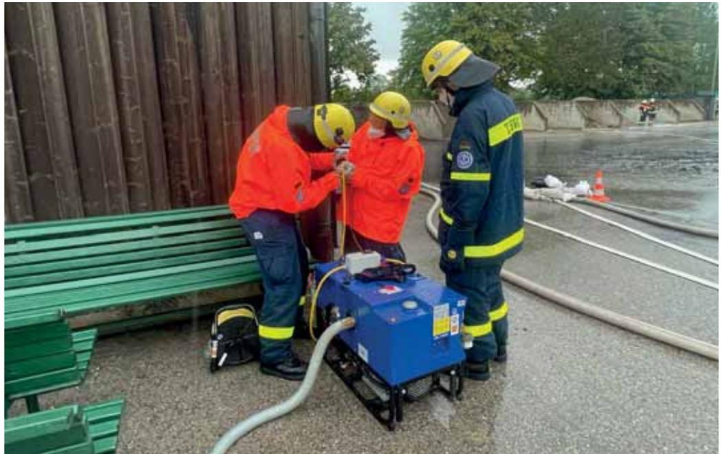
THW-Einsatzkräfte beim Anschließen der Schmutzwasserpumpe.
