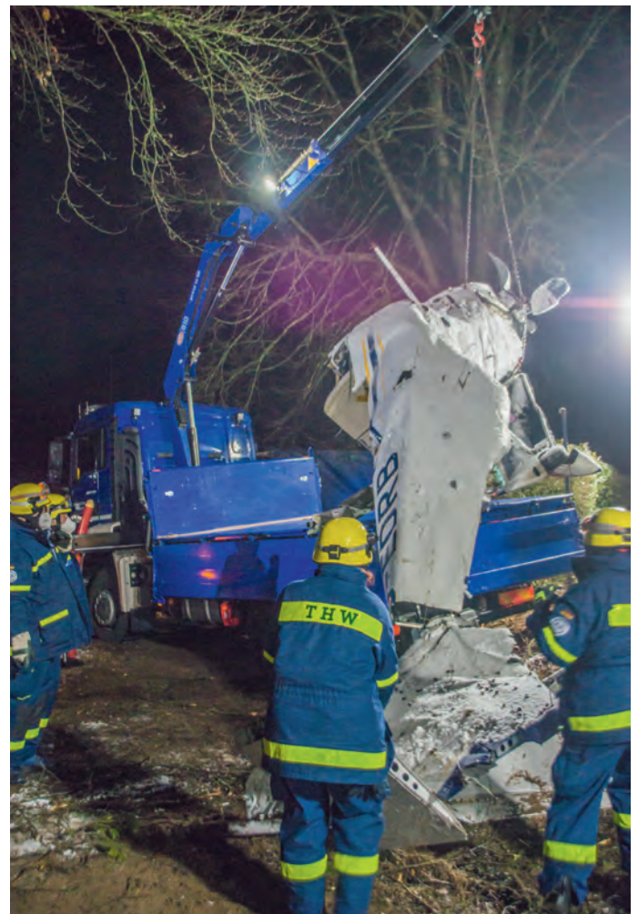
Bei der Verladung stabilisierten Helfer das Heck, damit es nicht weiter schwingen und abbrechen konnte.
