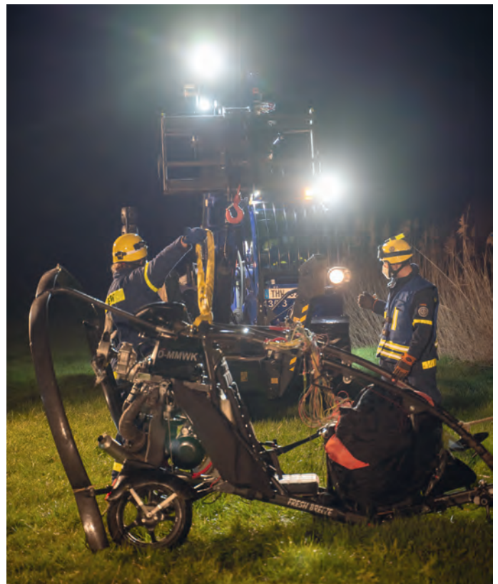
Bergung des Fluggerätes mittels Teleskoplader.
