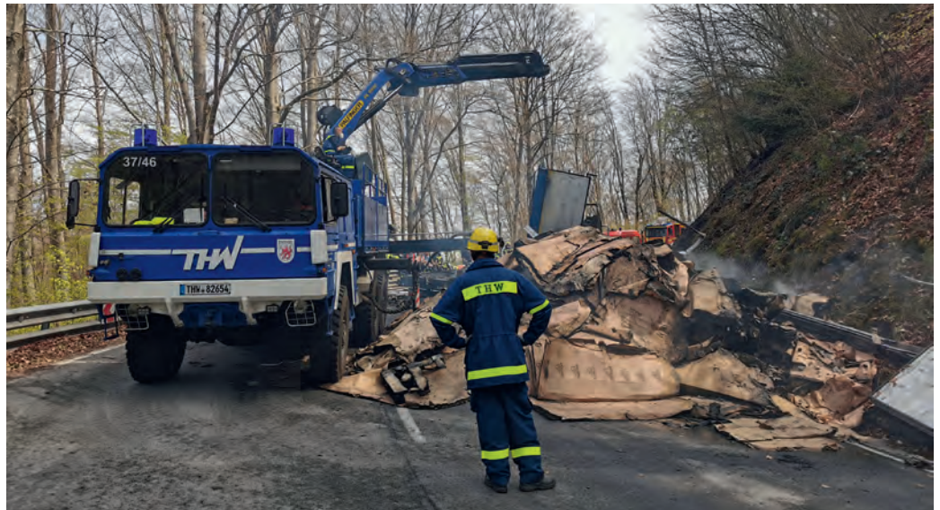
Teile des Aufliegers müssen mit Kran vom LKW getrennt werden.
