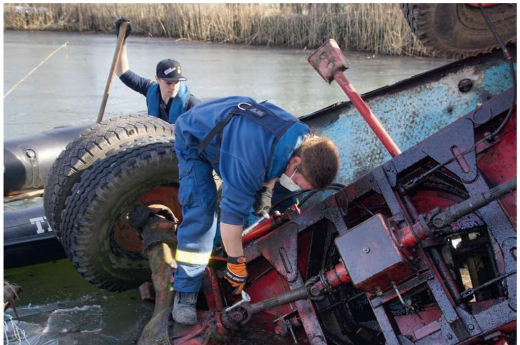
Nach der Sicherung mit Greifzügen wird am verunfallten Bagger vom Boot aus die Kardanwelle entkoppelt, um das Gefährt für die Phase nach dem Aufstellen bewegbar zu machen (Harald Wieberger und Leonhard Deinbeck).
