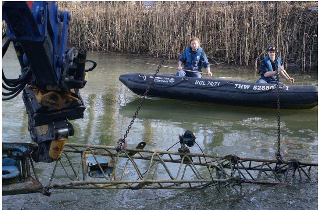
*Der unter Spannung stehende Kranarm des Unfallbaggers wird – gesichert über den Kran der Logistik – von Baggerführer Stefan Bauer aus sicherer Entfernung mit der Stahlschere der Rettungsspinne gekappt*
