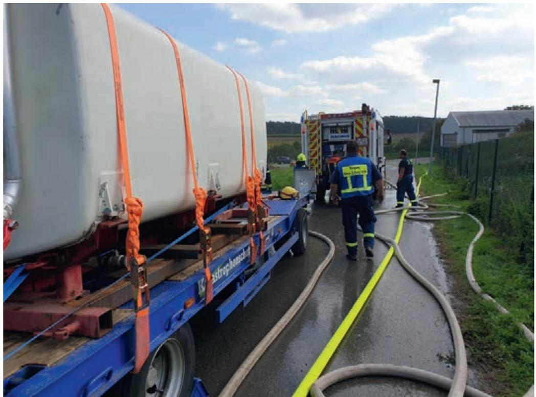
Der 10 m<sup>3</sup> fassende Wassertank wurde als Puffer zur Löschwasserbereitstellung für die Angriffstrupps der Feuerwehr verwendet.
