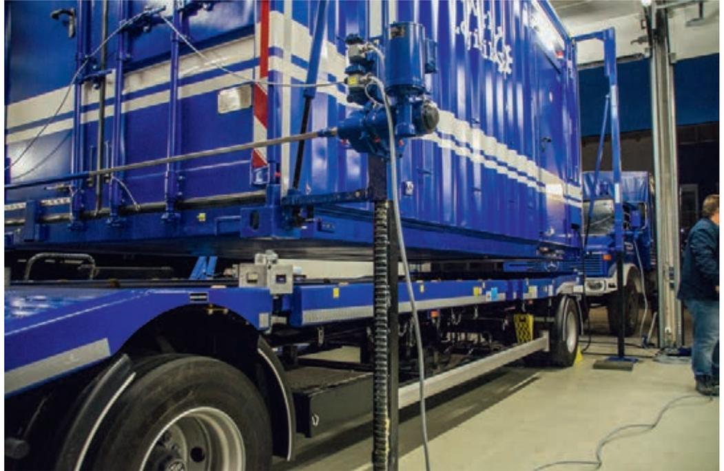
Mit hydraulischen Stützen kann der Container vom Anhänger gehoben werden.
