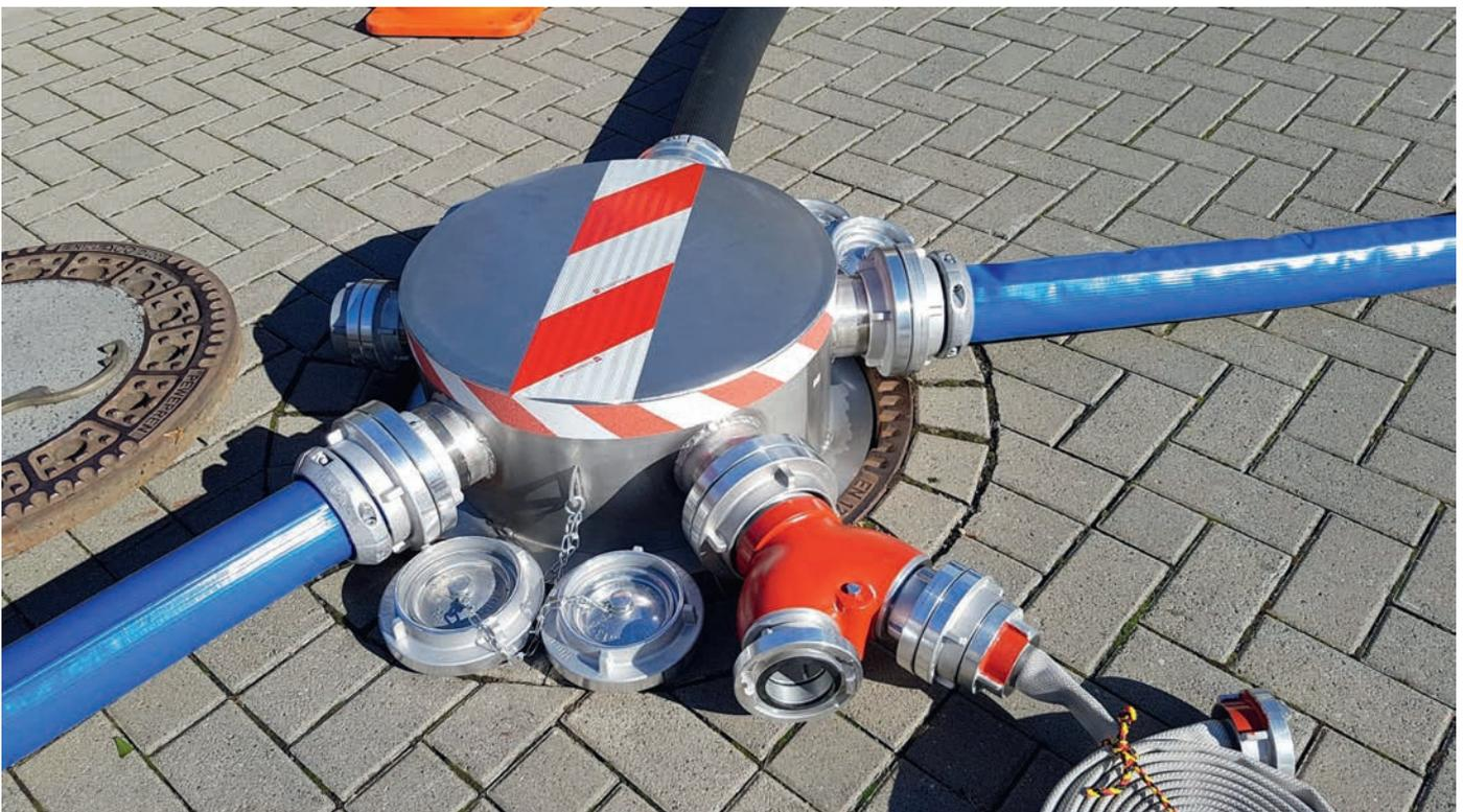
Bei der SET Typ A befindet sich unterhalb der zwei B- und vier A-Storz-Anschlüsse der Auflagering, der auf jeden genormten Schacht passt. Warnmarkierungen sichern die Einsatzstelle.
