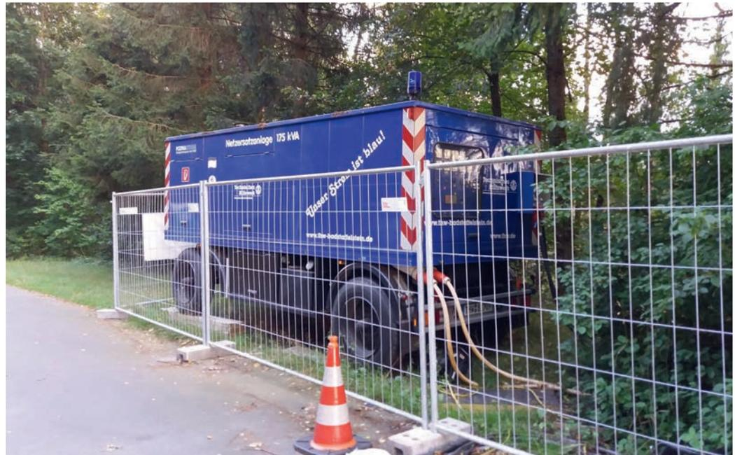
3 große Netzersatzanlagen des THW waren von Februar bis August vor Ort, um den nötigen Strom für die Pumpen zu erzeugen.
