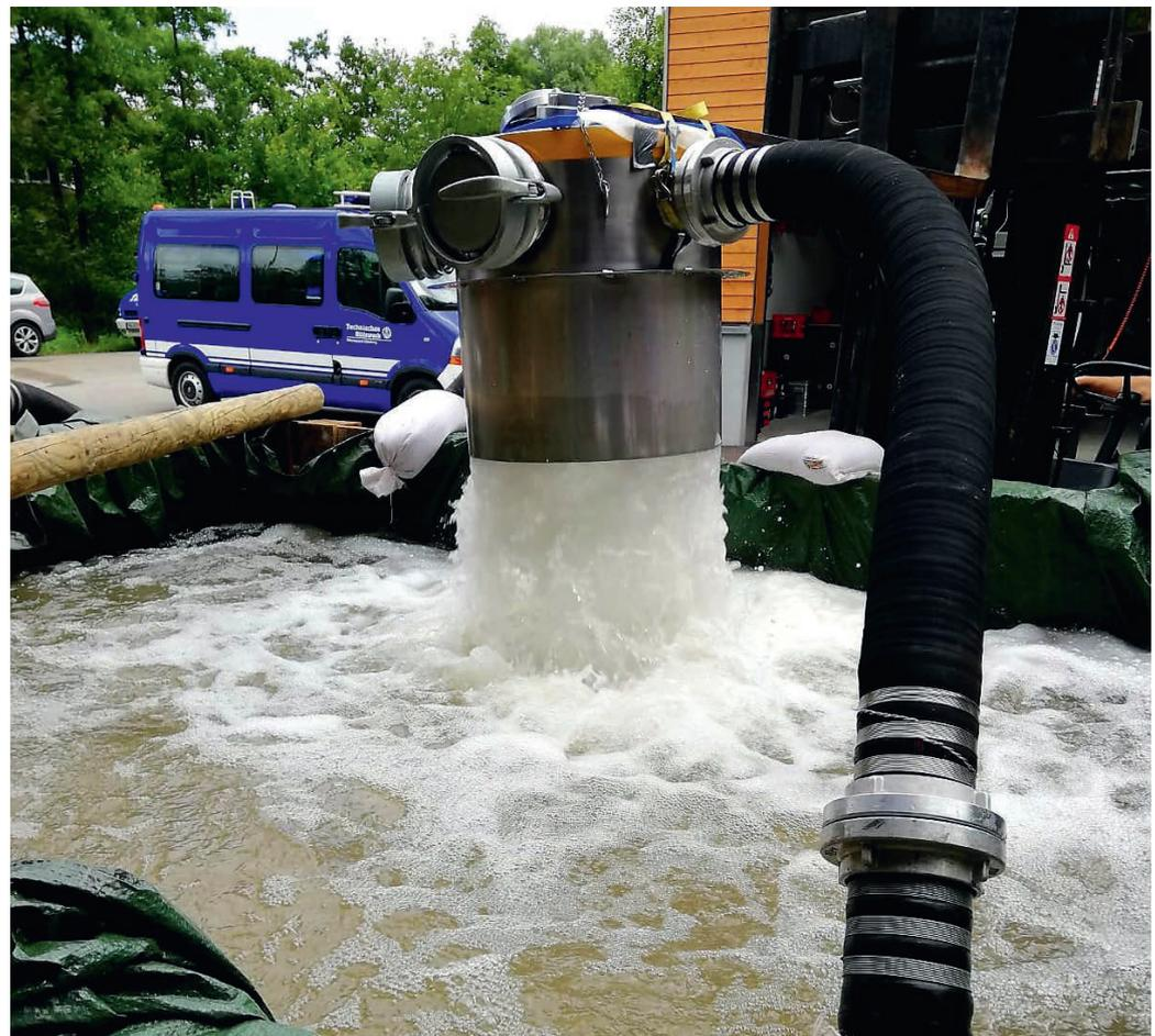
Erprobung im THW-OV Backnang: aus dem zylindrischen Auslauf kommen 6.000 Liter pro Minute
