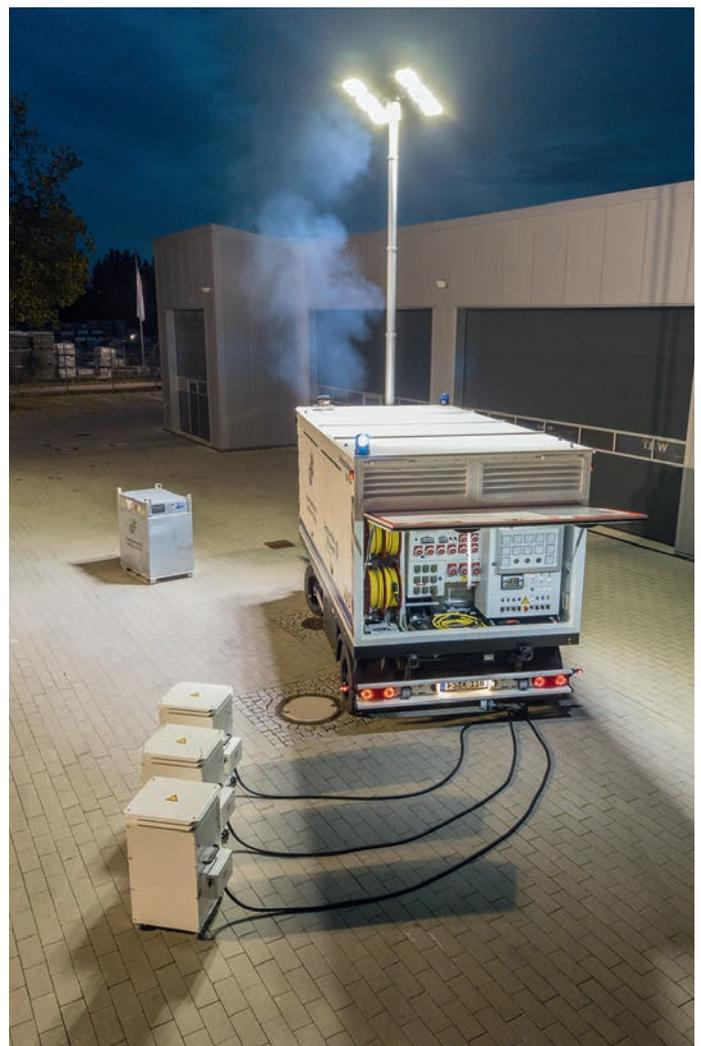
Die zur Netzersatzanlage gehörenden Heizwiderstände neben der Anlage, im Heck sind Bedienpult und Schaltschrank integriert.
