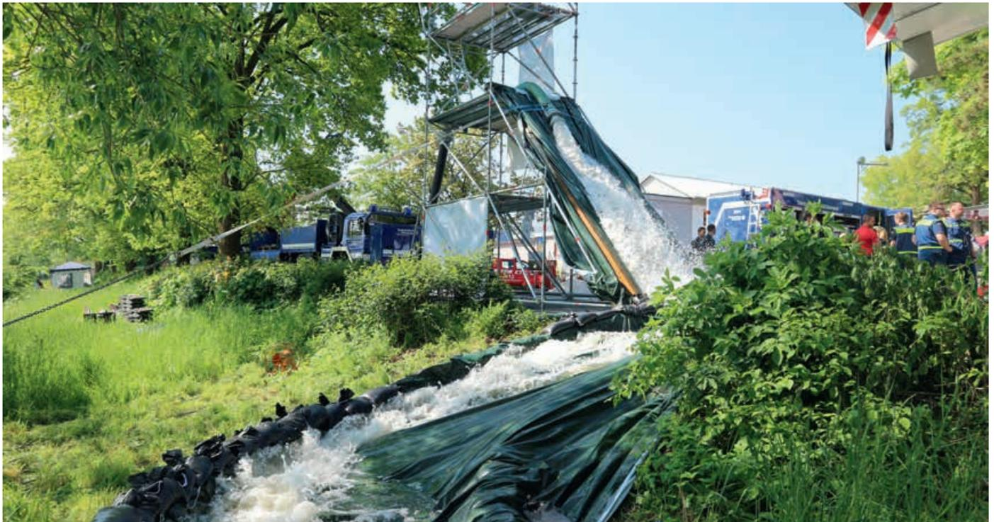
Wasserfall - produziert mittels der Großpumpe und EGS (Einsatzgerüstsystem) und diversen Teilen.
