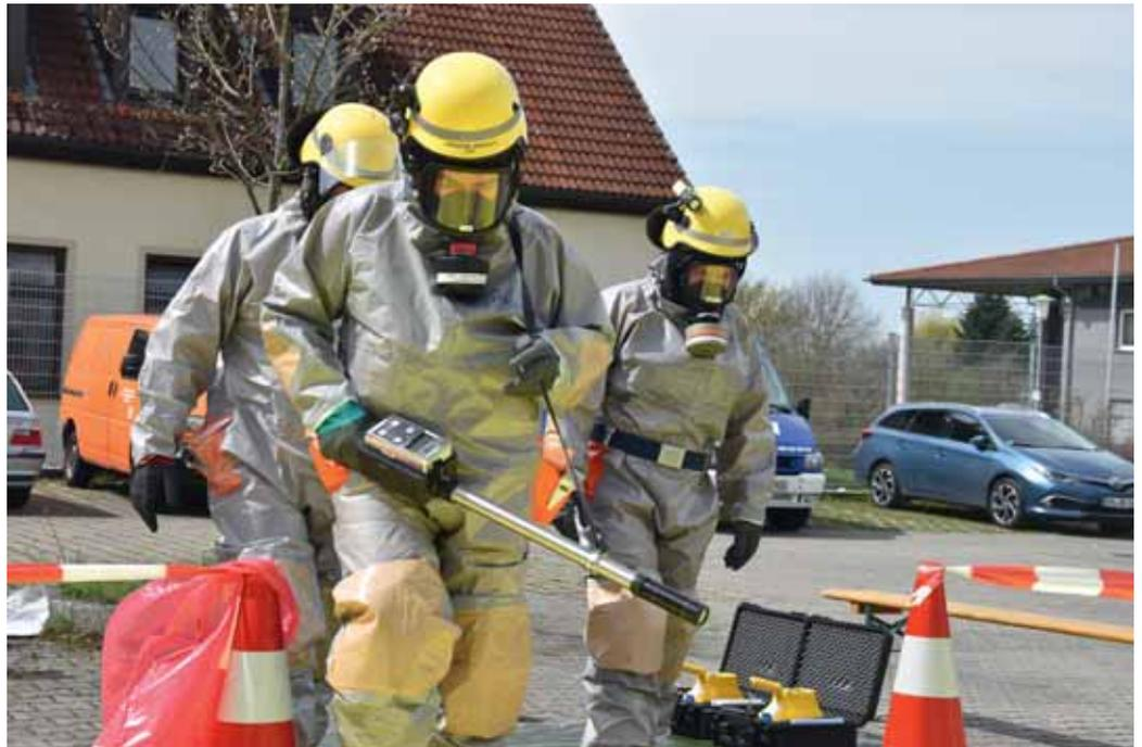
Mit Hilfe des Dosisleistungsmessgerätes spüren die eingesetzten THWler Strahlenquellen auf.
