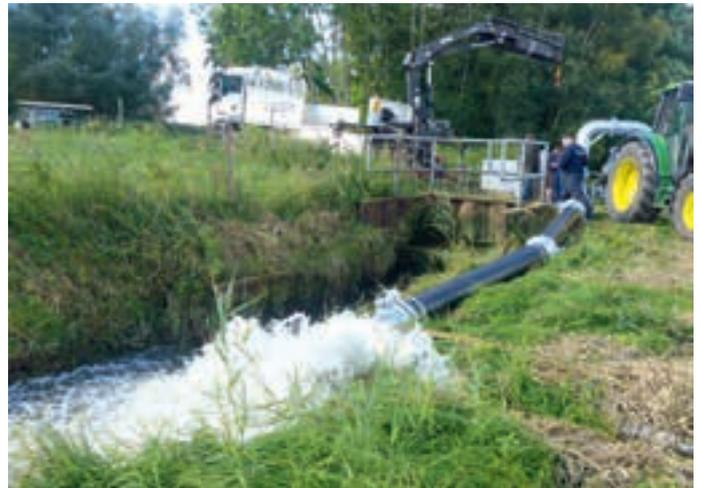
Die selbstansaugende Kreiselpumpe BBA B300 mit maximaler Förderleistung von 1.200 Kubikmetern pro Stunde.
