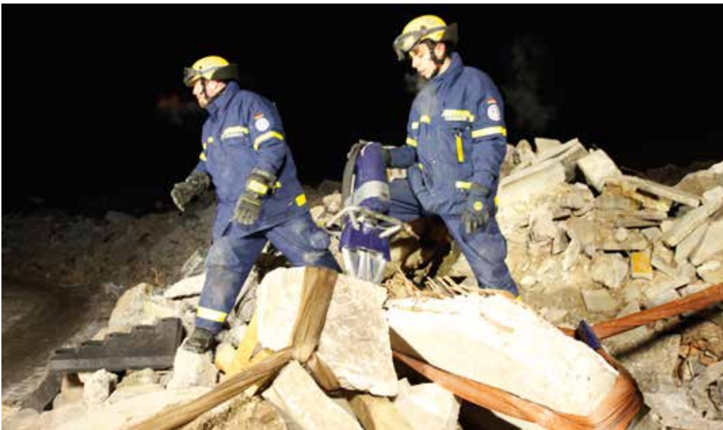
Vom Seilzug über pneumatische Hebekissen bis zum modernen Akkubetriebenen Rettungsspreizer: alles wird eingesetzt.
