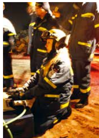
Mit den Hebekissen wird die tonnenschwere Betonplatte angehoben - von Caro gesteuert.
