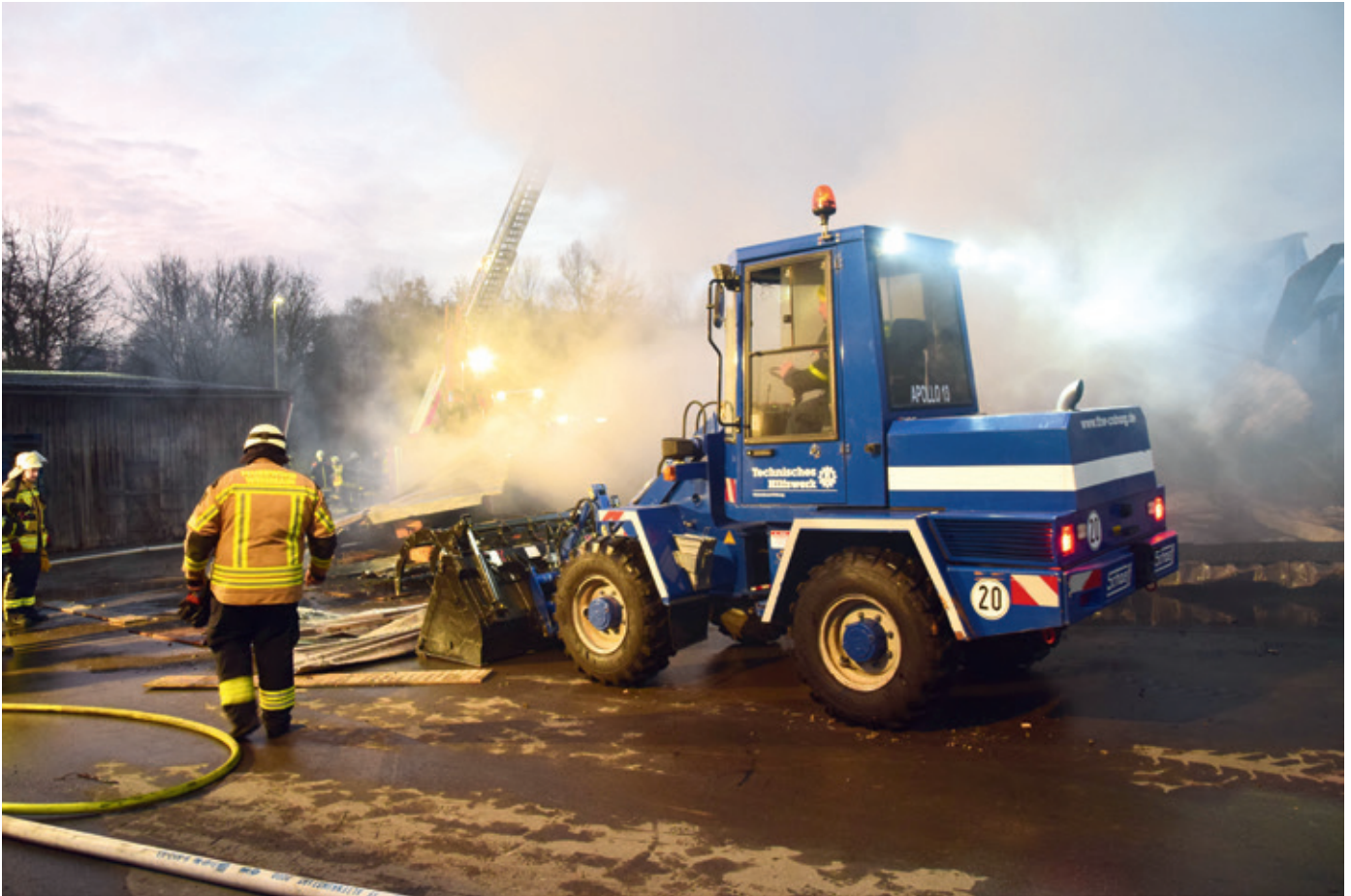
Beräumen von Trümmern mit dem kleinen Radlader der FG R aus dem OV Coburg.
