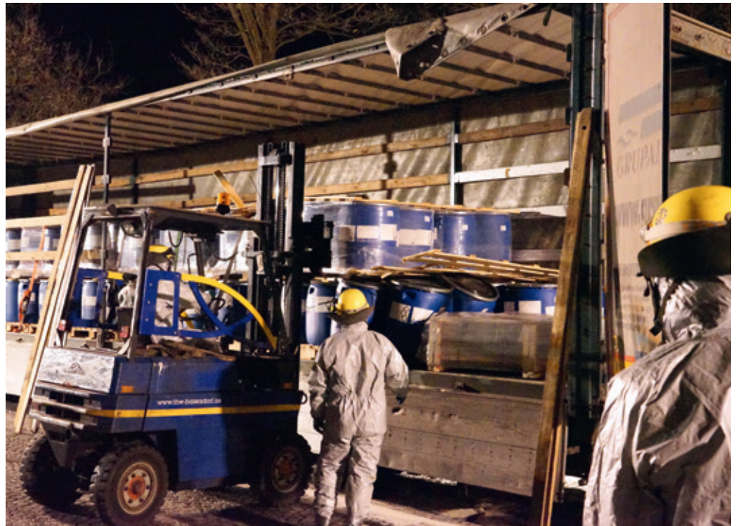
Mit dem Gabelstapler werden unbeschädigte Fässer vorsichtig geborgen.
