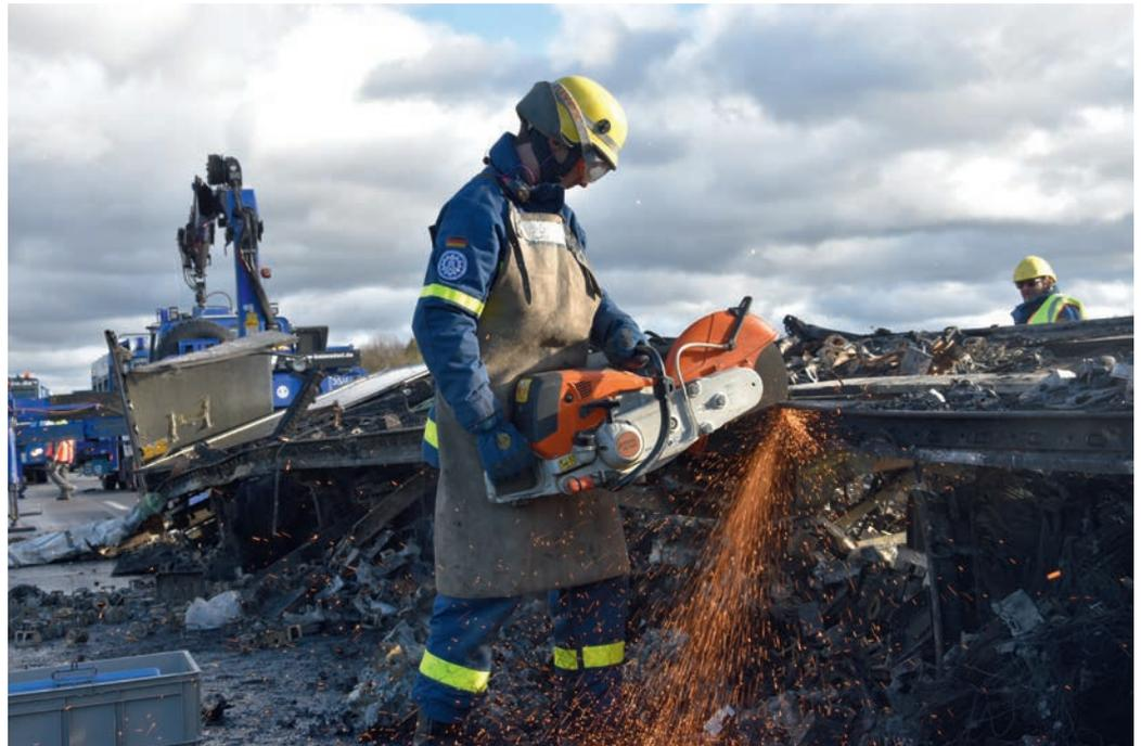
Zur Trennung des Sattelauflegers von der Sattelzugmaschine kommt der Motortrennschleifer zum Einsatz.
